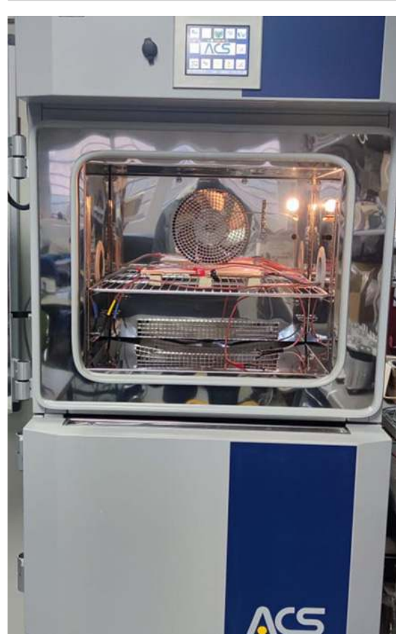
Figura 7. Cámara climática del laboratorio de la unidad de Accionamientos Eléctricos del CIEMAT.
